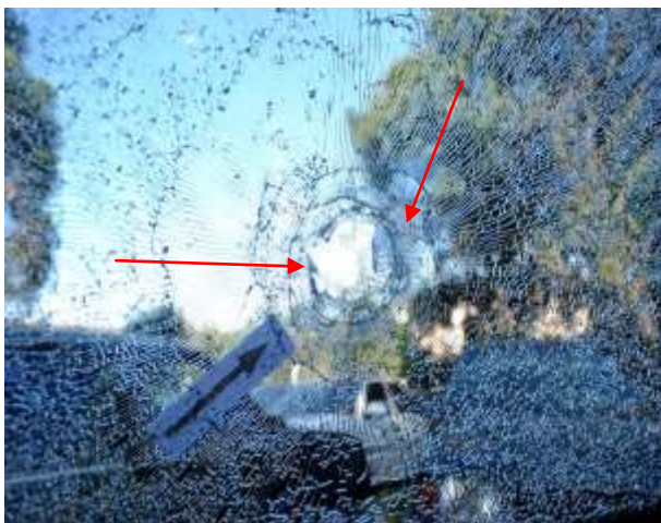
Figura 9. Cone de transfixação formado após disparo de projétil de arma de fogo. Seta aponta orifício de saída (cone). A força partiu do lado oposto ao cone
