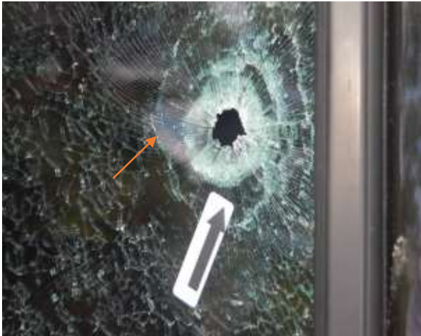
Figura 4. Seta vermelha indica a linha concêntrica pós impacto de projétil de arma de fogo.
