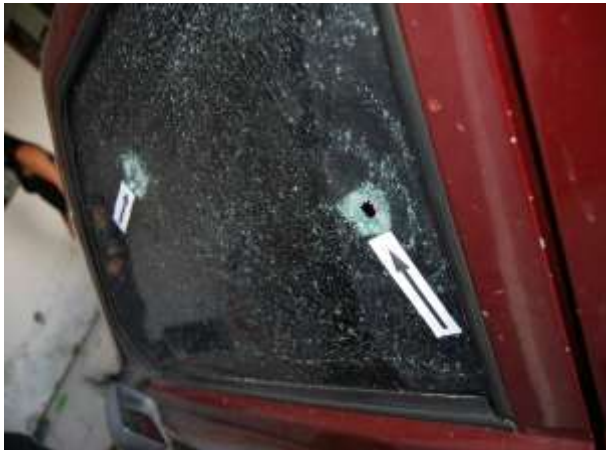
Figura 12. Veículo alvejado por disparos de arma de fogo. Seta mostra orifício de entrada de projétil de arma de fogo no vidro dianteiro esquerdo (cone de transfixação do lado interno do veículo). Trajetória: esquerda para direita (fora para dentro).
