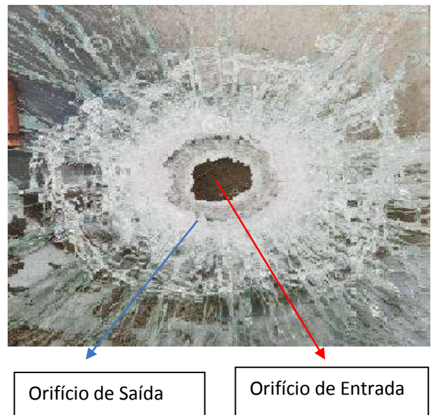
Figura 7. O cone formado pós disparo de arma de fogo em superfície de vidro permite definir o sentido da trajetória do disparo. O orifício de saída (lado oposto ao atirador) é maior do que o orifício de entrada.
