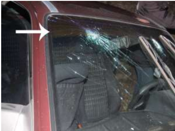
Figura 1. As setas demonstram presença de linhas radiais pós disparo de projétil de arma de fogo em vidro de automóvel.
