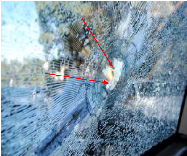
Figura 8. Cone de transfixação formado em vidro. O disparo partiu da esquerda para direita e as setas nos mostram o orifício de saída do projétil de arma de fogo.
