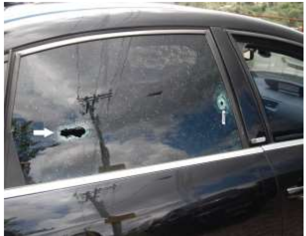
Figura 11. Seta demonstrando trajetória de um projétil de arma de fogo. Cauda de entrada se forma no ponto de impacto do projétil com o vidro Trajetória (na foto): Esquerda para direita.
