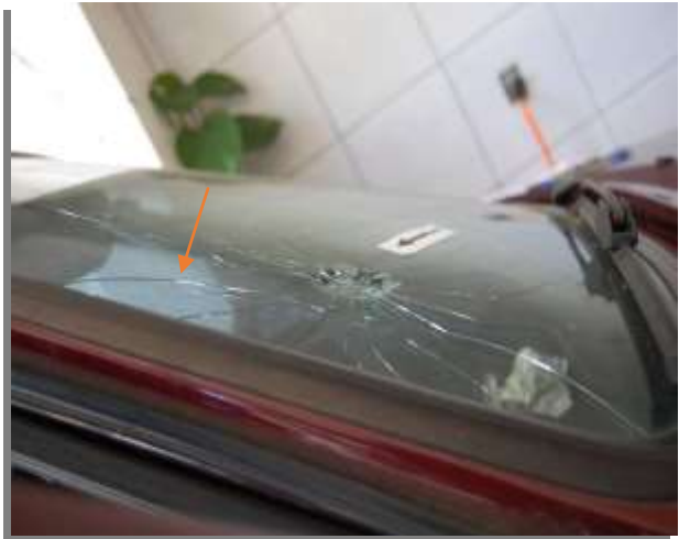
Figura 3. Rupturas radiais originadas a partir do ponto de impacto. (Seta preta nos aponta o local de impacto e as setas vermelhas nos mostram rupturas radiais).
