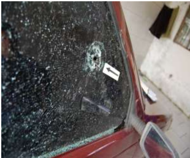
Figura 13. Saída de projétil de arma de fogo em vidro dianteiro direito do veículo (cone de transfixação demonstrado pela seta) Trajetória: da esquerda para direita.
